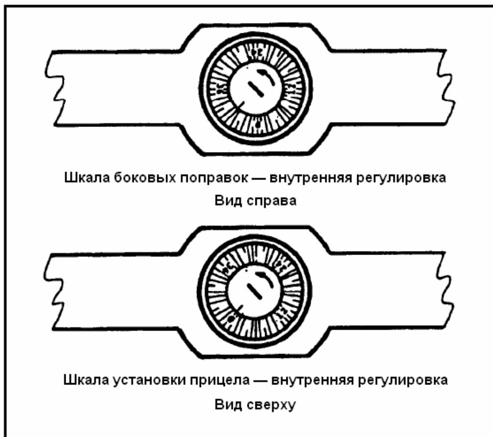
Рис. В-10. Шкалы установки прицела и боковых поправок.
